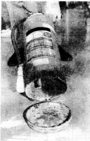
腐食が進み破裂した消火器
