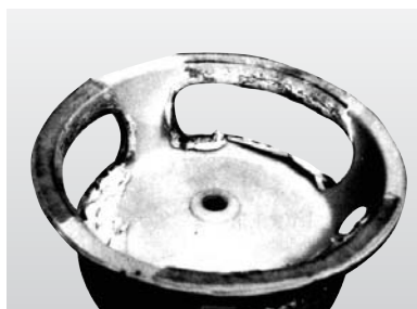
・表面溶解による変形
